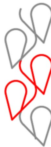
Figura 1b - Pontos de entrelaçamento do tipo Tricot fechado.
