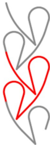
Figura 1a - Pontos de entrelaçamento do tipo Tricot aberto.
