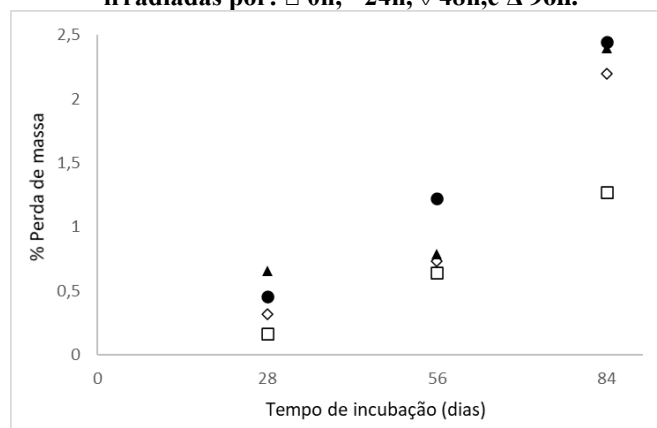
Figura 3. Perda de massa das amostras de PET em diferentes períodos de incubação, para os amostras irradiadas por: □ 0h, • 24h, ◇ 48h, e △ 96h.
