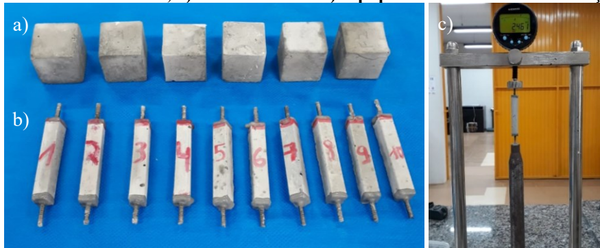
Figura 1 – a) CP's de 30x30x30 mm, b) 10x10x40 mm e c) Equipamento de leitura de variação dimensional.
