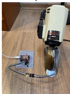
Figura 2 – Acelerômetro acoplado na carcaça da máquina
