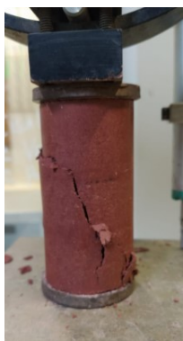
Figura 1 – Corpo de prova submetido ao ensaio de compressão simples
