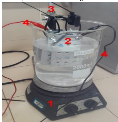
Figura 01. Reator eletrolítico utilizado nos ensaios de eletrocoagulação: 1. Agitador magnético; 2. Eletrodos; 3. Suporte universal; 4. Conectores ligados a fonte de tensão.
