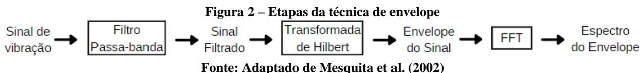
Para obter o espectro, foi utilizado a função da *Fast Fourier Transform* (FFT), a qual está disponível no MATLAB. O filtro passa-banda foi projetado com o uso da função *fir1*, com banda de passagem entre 2000 e 5000 Hz.
