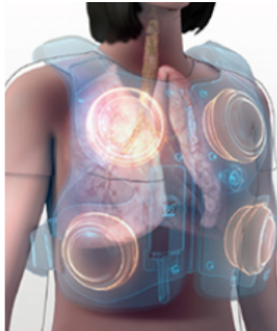
Figura 1 – Exemplo de distribuição dos motores no colete The Vest
