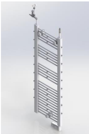
Figura 3. Diagrama esquemático do trocador de calor (aquecedor) tipo radiador tubular.
