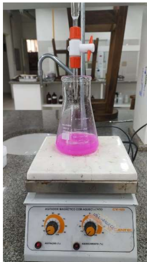
Figura 2 - Amostra de hidróxido de sódio cessada com cloreto de bário e adicionada fenolftaleína
