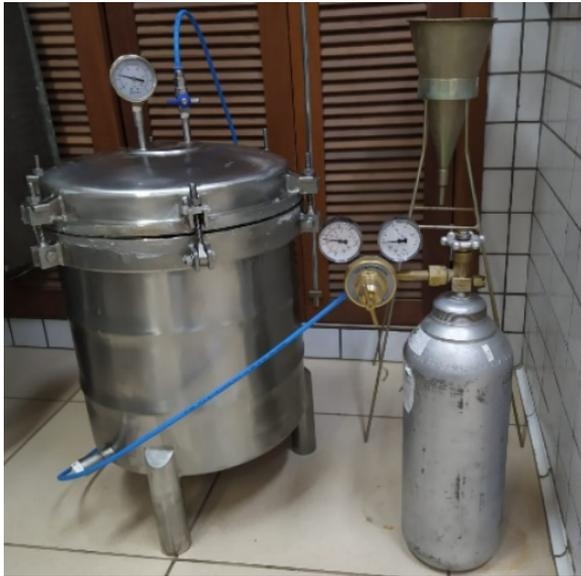
(a) Câmara de carbonatação do concreto.
