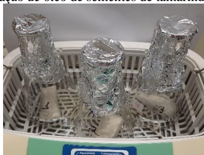
Figura 2 - Extração de óleo de sementes de tamarindo por ultrassom.
