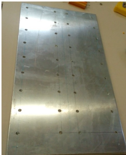
Figura 2 - Placa de alumínio utilizada como meio resfriador.
