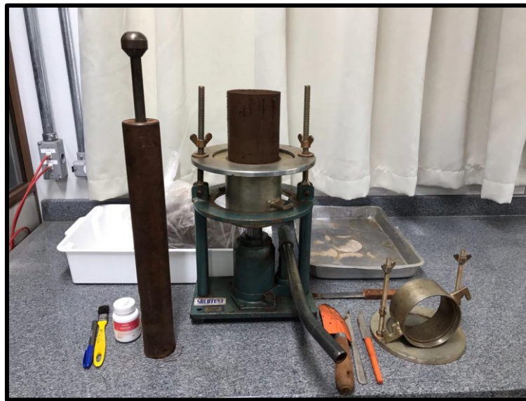
Figura 1 – Material utilizado para realização do ensaio de Proctor.
