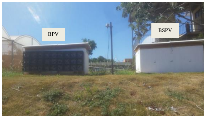
Figura 1 - Modelos construídos com e sem a implementação do módulo de parede verde
