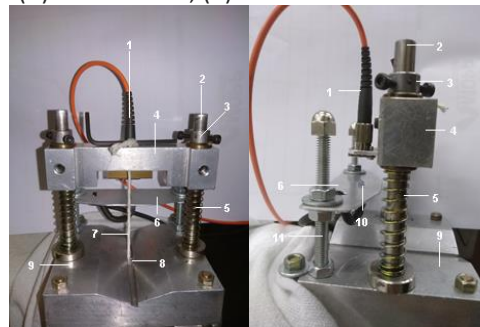
Fig.3.(A).Vista frontal; (B) Vista lateral da célula de carga
