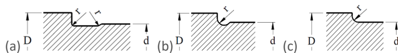
Figura 1. Geometrias de rebaixo de eixos: (a) Geometria A – DIN 509, (b) Geometria C – DIN 509 e (c) Filete simples.
