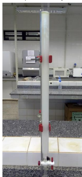
Figura 1 – Cromatografia em coluna para o isolamento dos compostos do óleo essencial da espécie E. uniflora .
