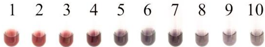
Figura 3 – Amostras de AuNP em água com uma ordem crescente de níveis de aglomeração.
