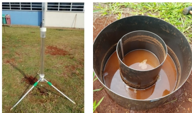
Figura 1 – Ensaios de permeabilidade em campo (a) permeâmetro Guelph (b) infiltrômetro do duplo anel
