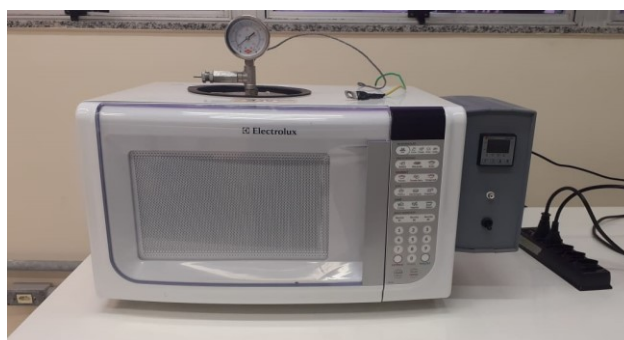
Figura 2– Imagem do forno micro-ondas com um controlador PID adaptado.
